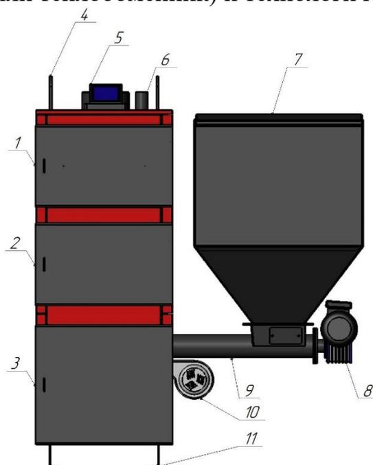
Рисунок 5. Схема размещения составных элементов в котлах серии VULKAN Eko (вид с фронта). 1-дверца теплообменника; 2-дверца горелки; 3-дверца зольника; 4-ухо транспортировочное; 5-контроллер; 6-труба подачи; 7-бункер; 8-мотор-редуктор; 9-труба топливоподачи; 10-вентилятор наддува; 11-опора котла.
