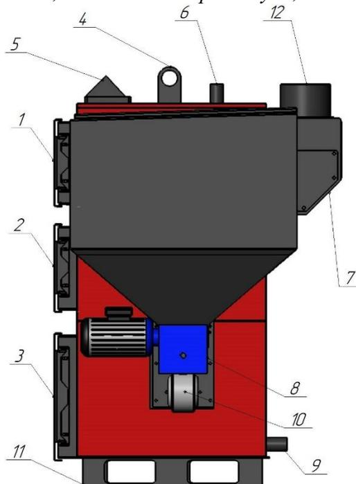
Рисунок 6 — Схема размещения составных элементов в котлах серии VULKAN Eko (вид сбоку). 1-дверца теплообменника; 2-дверца горелки; 3-дверца зольника; 4-ухо транспортировочное; 5-контроллер; 6-труба подачи; 7-короб дымохода; 8-мотор-редуктор; 9-труба обратной линии; 10-вентилятор наддува; 11-опора котла; 12-дымовая труба.
