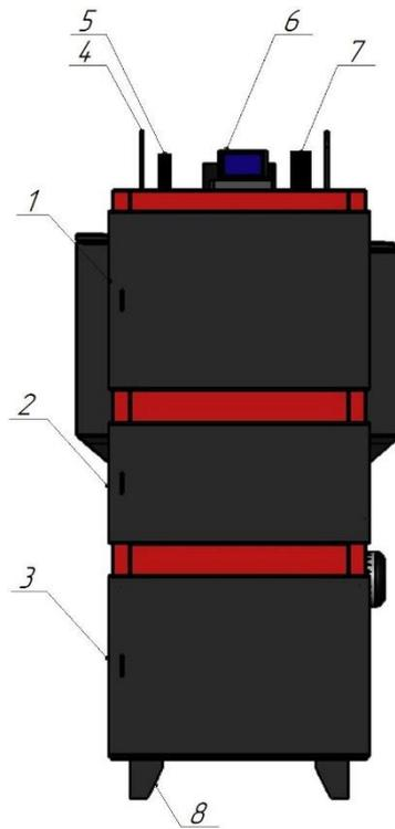
Рисунок 7 — Схема размещения составных элементов в котлах серии VULKAN Eko Z (вид с фронта). 1-дверца теплообменника; 2-дверца горелки; 3-дверца зольника; 4-ухо транспортировочное; 5-группа безопасности; 6-контроллер; 7-труба подачи; 8-опора котла
